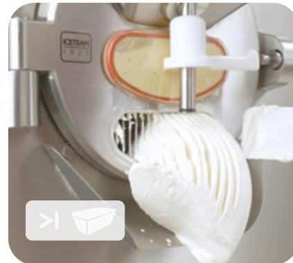
**Estrazione SMART** - Controlla l'estrazione impostando il numero di vaschette di Gelato che vuoi estrarre e Vario Icona doserà la velocità per consentire le operazioni di sostituzione della vaschetta e ti avviserà con segnali acustici.
