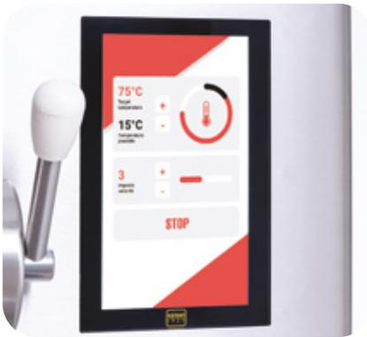
**Pastorizzazione** - Utilizzando la funzione “riscaldamento” si avvia un ciclo regolabile fino a 105°C.
